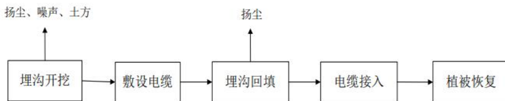
图 2-4 电缆线路工程施工工艺流程图
