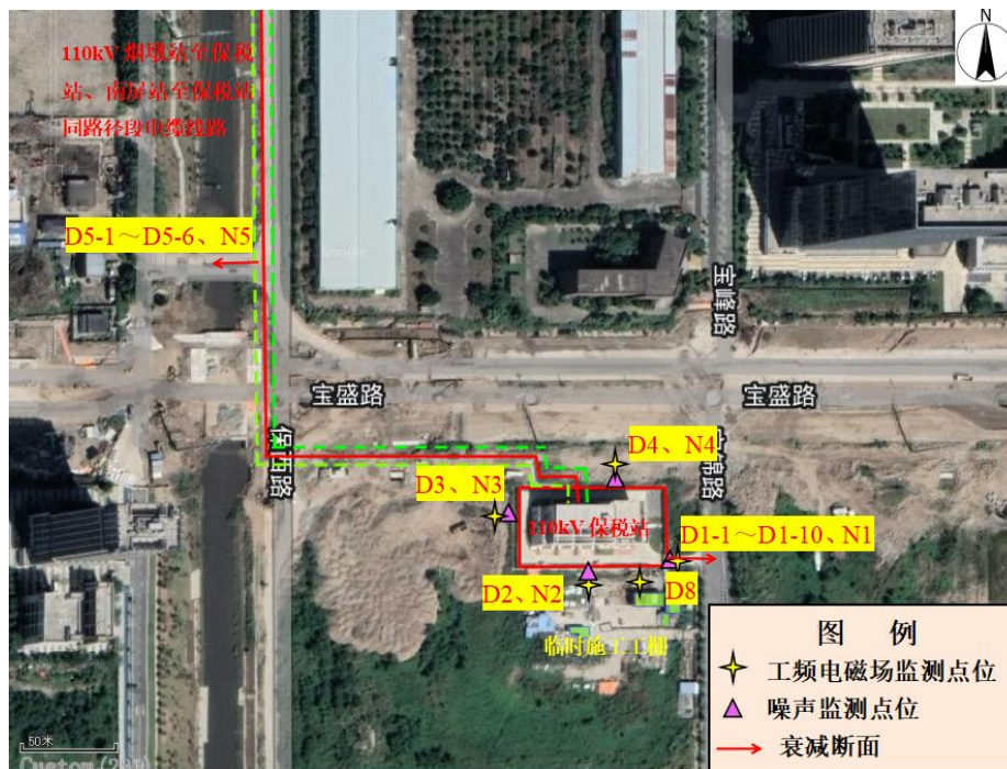
图4-1 珠海110千伏保税站工频电场、工频磁场监测布点示意图
