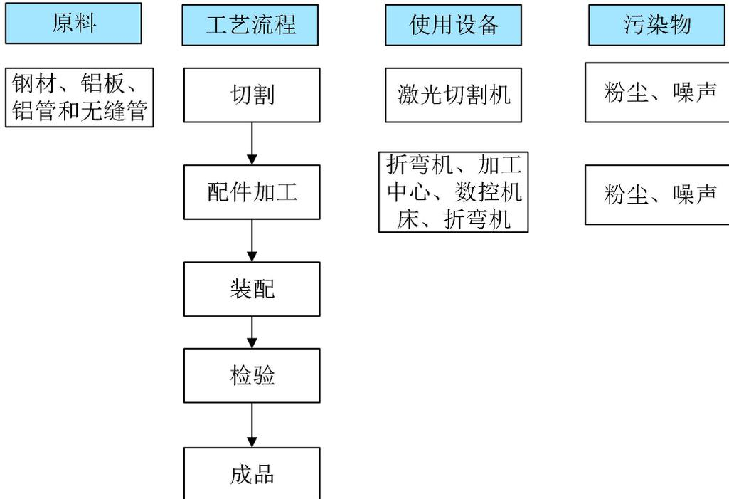
**图 2-3 模具加工生产工艺流程图**
