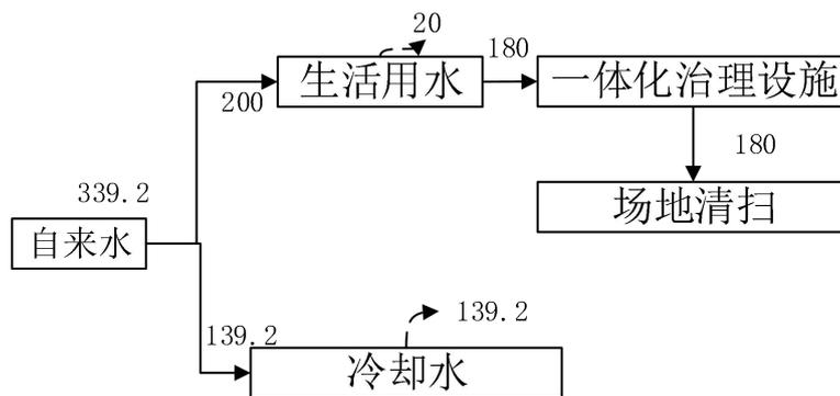
图 2-1 项目水平衡图（单位：m<sup>3</sup>/a）
