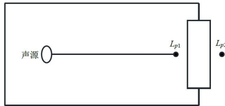
图6.5-1 室内声源等效为室外声源图例
