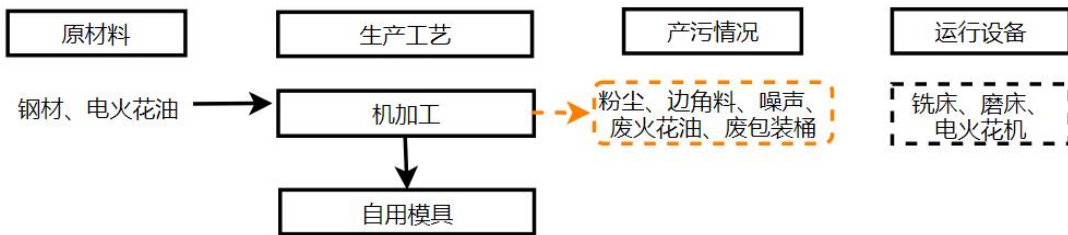
图4 项目自用模具生产工艺流程及产污环节图
