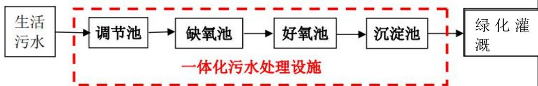
图 4-1 项目生活污水处理工艺流程图
