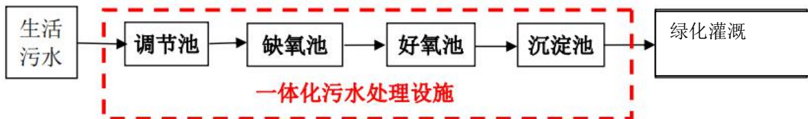
图 4-1 项目生活污水处理工艺流程图
