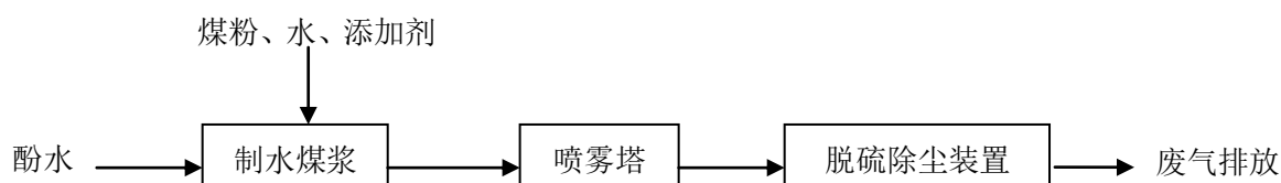
图 2.2-6 含酚废水处理工艺
